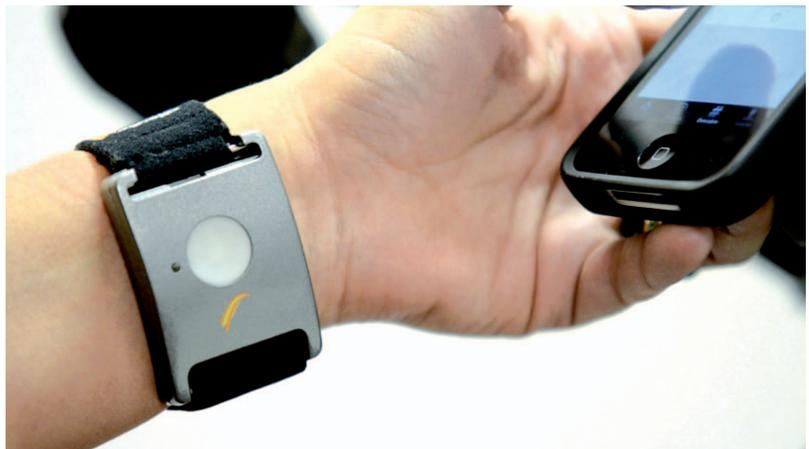
*Biosensor Qsensor del laboratorio UX Research de Redbility*
