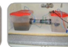
Cámara anaeróbica con orina y aeróbica con agua
