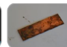
Electrodo de cobre, corrosión
