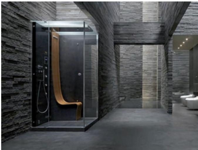
Jacuzzi Omega es una ducha integrada con hidromasaje y baño turco, diseñada para ofrecer un relax y regeneración corporal en un entorno doméstico. Incluye un generador de vapor, un rociador y un asiento curvado en madera Teak con cascada de agua. La ducha está producida en dos acabados diferentes, en blanco y negro piedra con cristales transparente.
